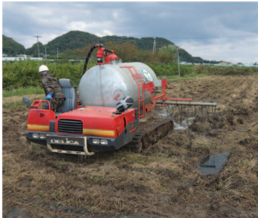
クローラタイプ散布車 京丹後市エコエネルギーセンター (水田転換畑の牧草栽培)
