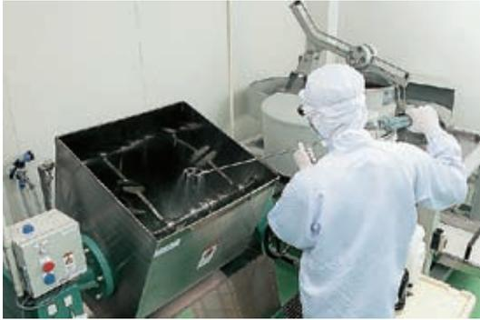
写真Ⅳ－11－3 荒茶に水分を加え菌株に適した水分含量に調整
