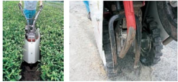
写真IV-4-1 歩行型カルチ(クランク式)による中・浅耕作業風景(左)とカルチの爪(右)
