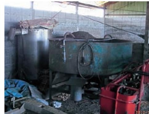
写真V-4-3 ぼかし肥を作成する機械
