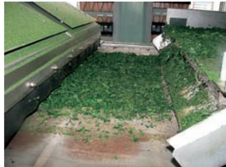
写真Ⅳ－11－7 高温加湿熱気処理機(2回目処理工程)に連続投入される茶葉
