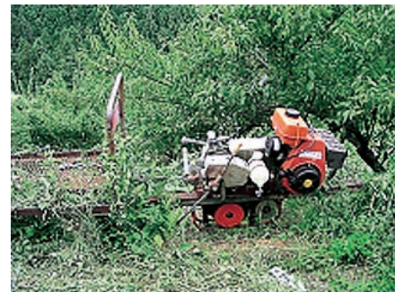
写真Ⅶ-16 堆肥や収穫物の運搬に使用するモノレール
