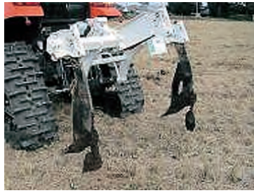
写真Ⅱ-3 弾丸暗渠の付いたサブソイラ（左）と弾丸の形状（右）
