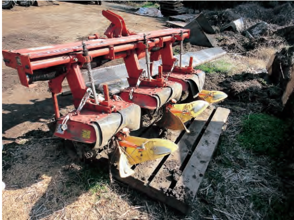
写真 I -13 トラクターの後部に取り付けられた 中耕培土機（熊本県 H 氏所有）
