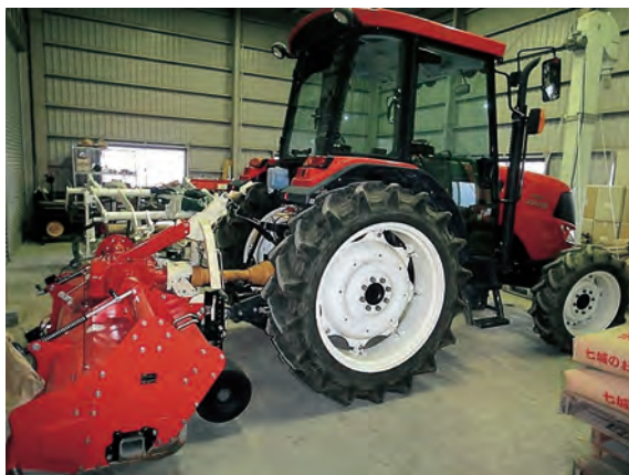
写真Ⅲ-21 麦わらの鋤込み、耕起同時播種に使用するトラクター
