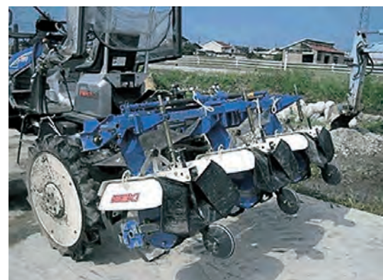
写真Ⅱ-5 ダイズ除草ロータ (DJ-3) (井関農機株式会社HP)
