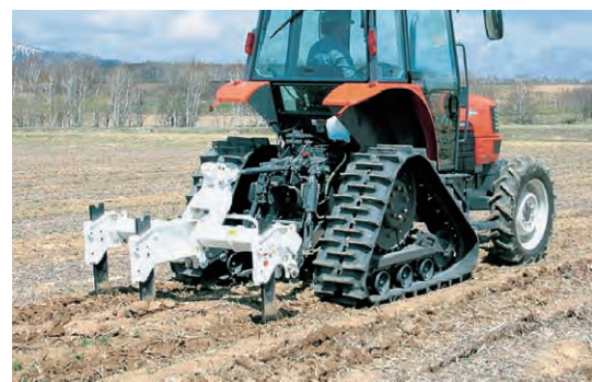
写真Ⅱ-2 サブソイラによる心土破碎作業 （株式会社クボタ資料）
