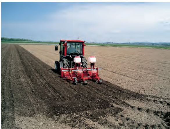
写真 I - 9 トラクターによる耕起同時播種 (提供：福士武造氏)
