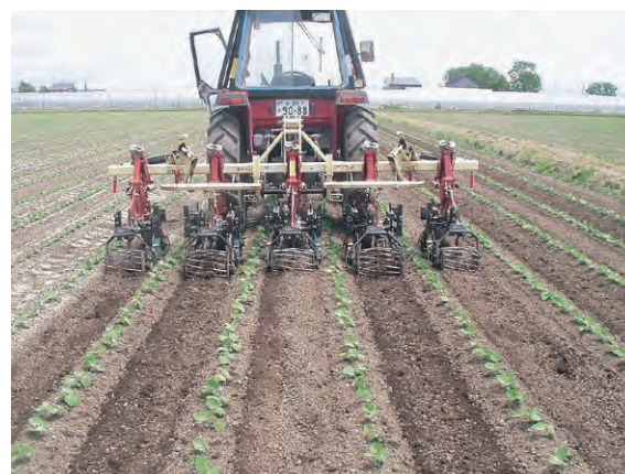
写真 I - 8 玉カルチによるボカシの混和作業 （提供：早川仁史氏）
