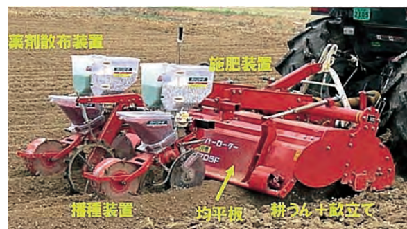
図 I - 24 耕耘同時畝立て播種作業機の構成 (独)農研機構作物研究所 2010)
