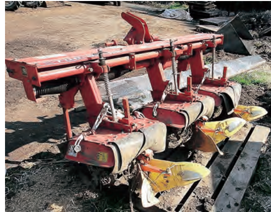
写真Ⅲ－23 乗用管理機（左）とカルチローター（右）
