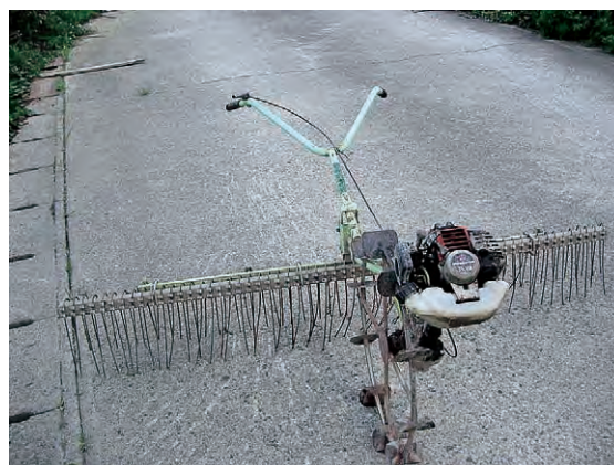
写真Ⅲ-16 チェーンと竹ぼうき除草の利点を活かしたワイヤー除草機
