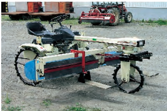
写真Ⅲ-6 ドロオイクリーナー (北海道農政部食の安全推進局 2007)
