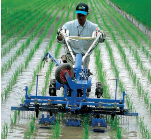
写真Ⅲ－34 歩行型揺動式除草機(井関農機)(左)、除草機で浮いてきた水田雑草(右)
