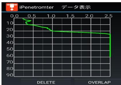
(貫入式硬度計での測定結果)
